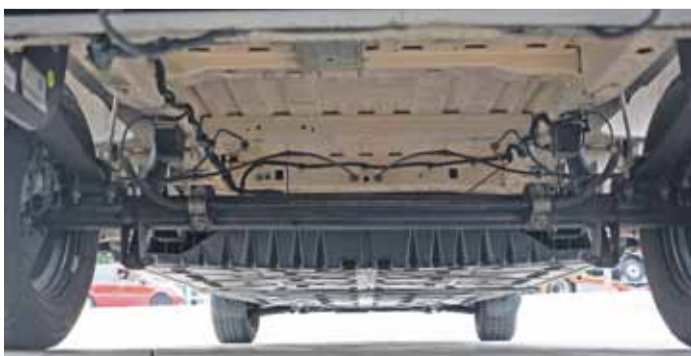
Alles nach vorn: Der kleine Akku ist ebenfalls vom e-Golf geliehen. Sein Vorteil: wenig Platz und Gewicht, kleinerer CO 2 -Fußabdruck.
